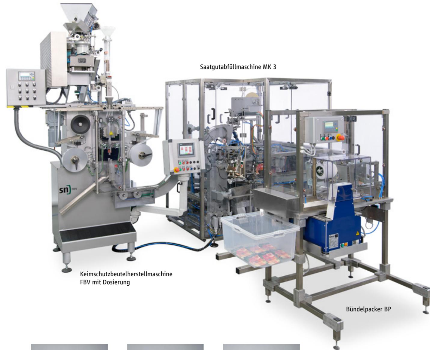
Keimenschutzbeutelherstellmaschine FBV mit Dosierung
