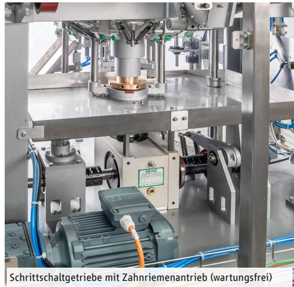
Schrittschaltgetriebe mit Zahnriemenantrieb (wartungsfrei)
