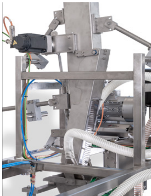
Servomotorische Produktfluss-Steuerung für großvolumige Produkte
