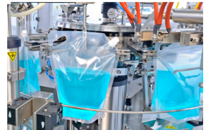
Abfüllung von Scheibenreiniger in Standbodenbeutel mit Corner-Spout
